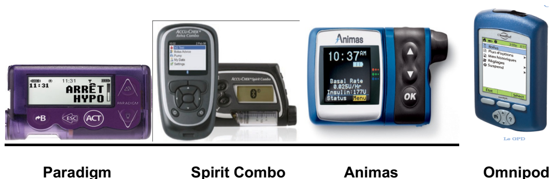
Fig 1 : Différents types de pompes à insuline externes
